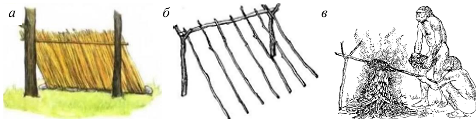
Рис. 2. Первая постройка примитивного жилища древнего человека (URL: https://pickimage.ru/detskie-risunki/school/history/pervobytnyj-chelovek/ ): а – ветровой заслон; б – каркас ветрового заслона; в – вертел над костром, как прообраз каркаса шалашей первобытных людей
