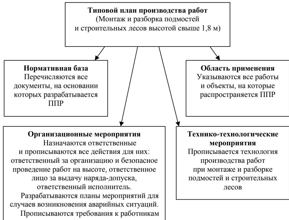
Рис. 2. Схема типового плана производства работ
