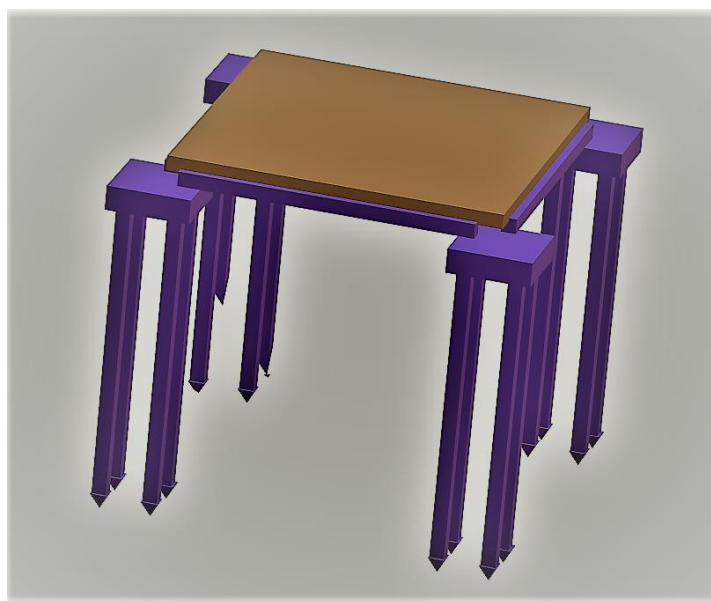
Рис. 1. Конструкция опирания плиты первого этажа
