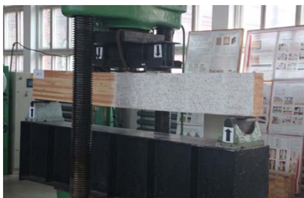
Рис. 3. Общий вид испытаний балки на поперечный изгиб
