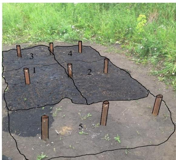
Рис. 2. Вид зоны загрязнения и зоны электрохимической обработки:
