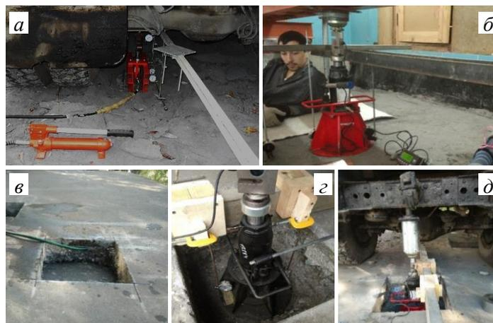
Рис. 2. Проведение испытаний в лотке и на земляном полотне из ЗШС:
