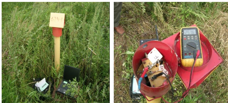
Рис. 2. Измерение плотности тока катодной защиты и плотности предельного тока по кислороду при различных потенциалах катодной защиты на трассе магистрального нефтепровода (фото А.В. Жилина)
