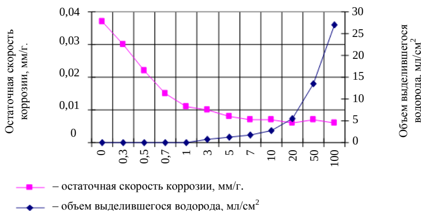
Рис. 1. Зависимость остаточной скорости коррозии и объема выделившегося водорода от степени превышения тока катодной защиты над предельным током по кислороду j_{к.з}/j_{пр}
