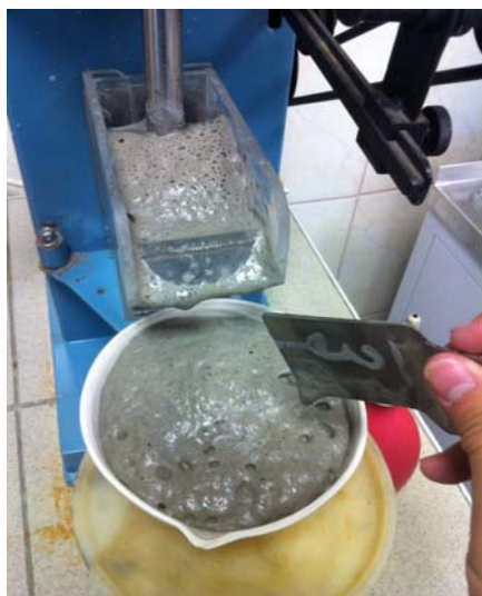
Рис. 1. Структура пены при флотации с пенообразователем ПО-6
