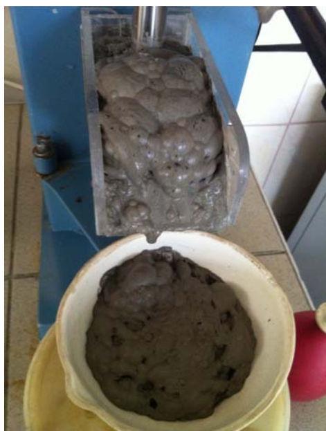
Рис. 2. Структура пены с добавками смеси жирных кислот ЖК-1
