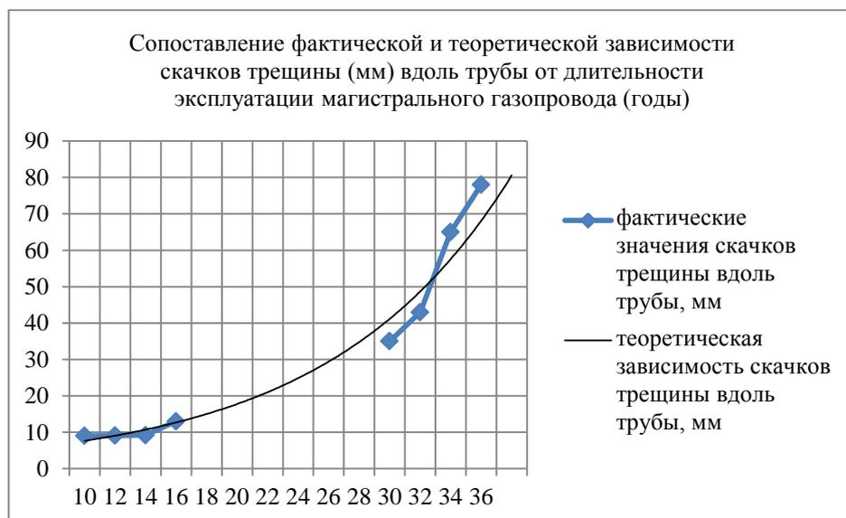
Рис. 5. Кинетика продвижения трещины вдоль трубы магистрального газопровода диаметром 1020 мм, толщина стенки трубы – 12 мм
