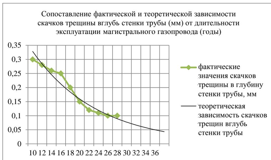
Рис. 4. Кинетика продвижения трещины вглубь стенки трубы магистрального газопровода диаметром 1020 мм, толщина стенки трубы – 12 мм
