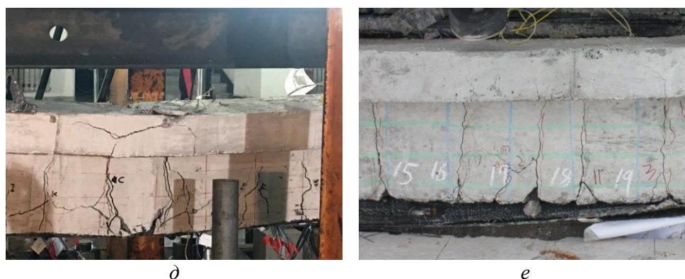
Рис. 6. Состояние разрушения типичных балок в испытаниях (начало см. на с. 89): д – L-3-1; е – L-3-2
