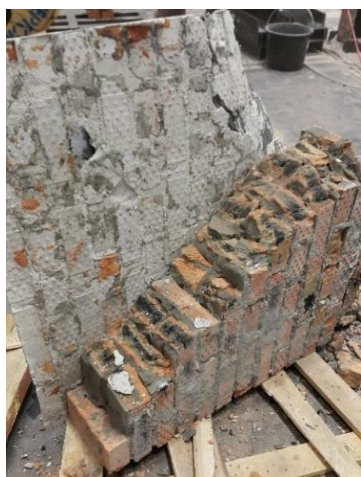
Рис. 2. Поверхность усиливаемых элементов при использовании ремонтного состава FibArm Repair FS
