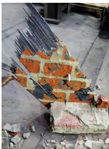
Рис. 3. Элемент усиления с поверхностным слоем кирпича и раствора
