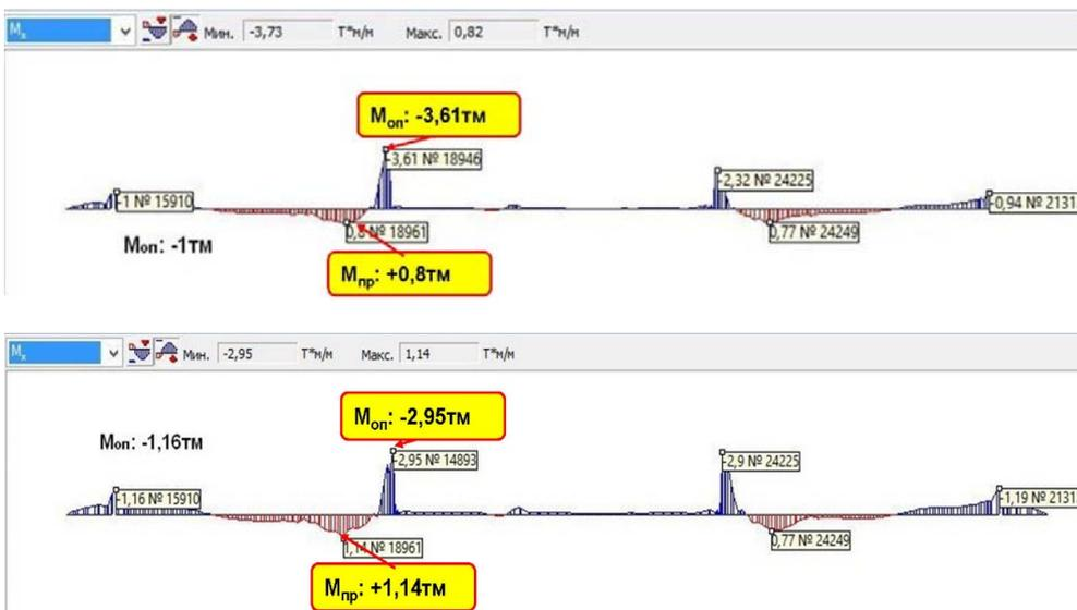
Рис. 7. Эпюры изгибающих моментов в перекрытии по линии оси «Ж» (см. рис. 1) от действия комбинации всех расчетных нагрузок: сверху – эпюры изгибающих моментов в результате расчета без учета формирования пластических шарниров; снизу – то же в результате многоэтапного расчета с учетом формирования пластических шарниров на этапе действия эксплуатационных нагрузок
