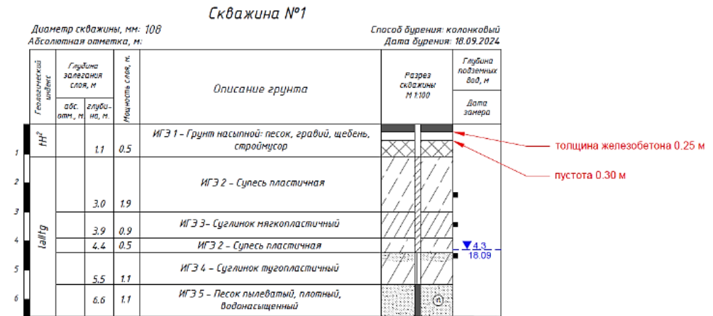
Рис. 3. Геолого-литологическая колонка скважины № 1 Fig. 3. Geological and lithological column of well 1
