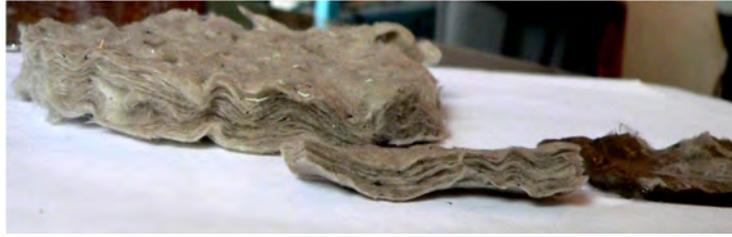
Рис. 1. Внешний вид образца из минеральной ваты. Слева направо: материал в сухом состоянии; после естественного высыхания; в состоянии полного насыщения водой
