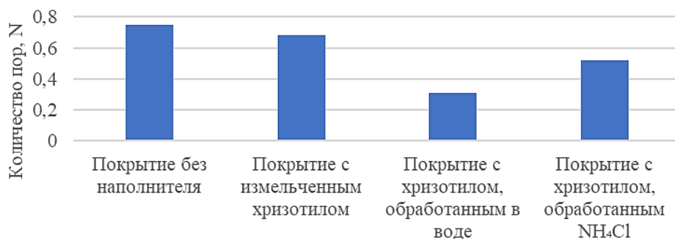
Рис. 7. Пористость эпоксидно-полиэфирных покрытий Fig. 7. Porosity of epoxy-polyester coatings
