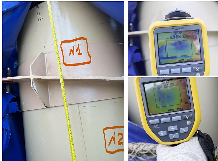
Рис. 5. Результаты тепловизионного исследования трубобетонной колонны Fig. 5. Examination of shotcrete column using the thermal camera
