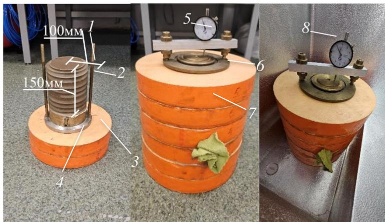
Рис. 1. Общий вид и конструкция прибора ППГ-1М для определения степени пучинистости грунта по ГОСТ 28622–2012<sup>7</sup>
