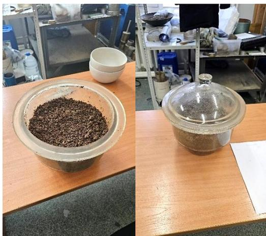
Рис. 3. Внешний вид увлажненного грунта суглинка пылеватого в эксикаторе
