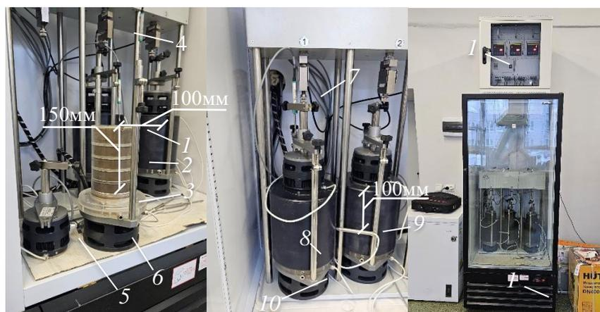
Рис. 2. Общий вид и конструкция прибора ГТ 1.1.8 НПП «ГЕОТЕК» для определения степени пучинистости грунта по ГОСТ 28622–2012<sup>9</sup>
