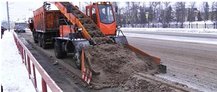
Рис. 3. Очистка дороги с использованием снегопогрузчика с автосамосвалом
