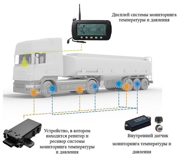
Рис. 8. Общая схема системы мониторинга (составлено автором на основе технической документации)
