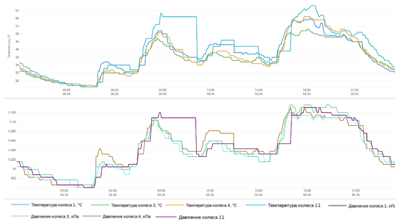
Рис. 16. Графики температур и давления в шинах 26.06 (построено автором по данным мониторинга на платформе Wialon)
