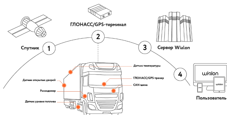
Рис. 11. Общая схема работы Wialon 1 Fig. 11. General scheme of Wialon operation
