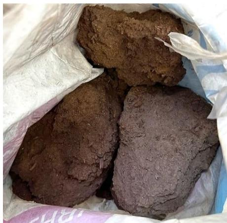
Рис. 3. Технический гидролизный лигнин
