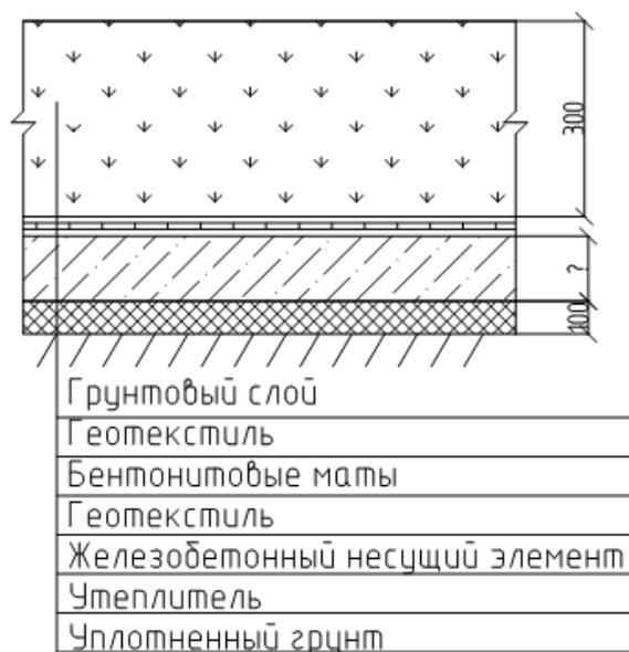
Рис. 4. Конструктивное решение открытой площадки резервуарного парка
