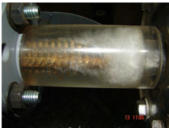
Рис. 10. Установившееся вихревое движение жидкости в выходном патрубке
