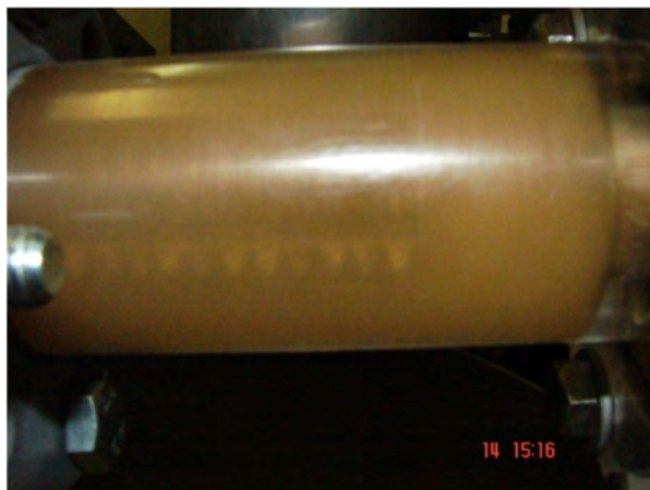
Рис. 13. Смешение различных жидкостей в выходном патрубке КСД
