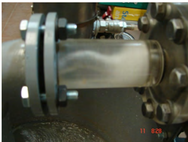
Рис. 3. Вихревое движение жидкости в выходном патрубке КСД при расходе 0,25 л/с и барометрическом давлении в центре улиточного завихрителя – 0,004 МПа
