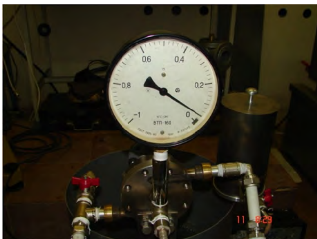
Рис. 4. Разряжение в центре улиточного завихрителя 0,004 МПа при расходе жидкости 0,25 л/с
