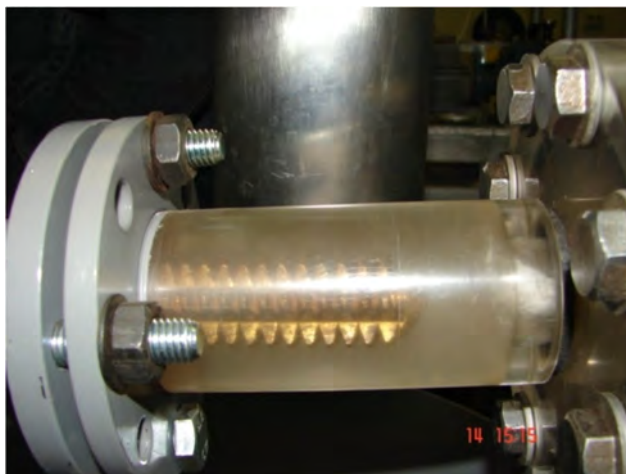
Рис. 11. Вихревое движение жидкости в выходном патрубке при барометрическом давлении -0,09 МПа в центре вихревой воронки улиточного завихрителя
