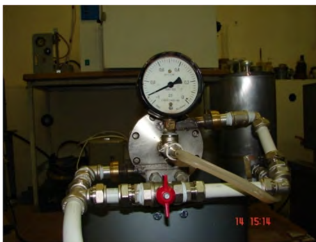
Рис. 12. Барометрическое давление -0,09 МПа в зоне вихревой воронки улиточного завихрителя
