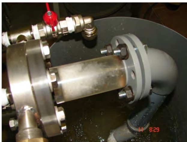
Рис. 6. Вихревое движение жидкости в выходном патрубке КСД при расходе 1 л/с и барометрическом давлении в центре вихревой воронки улиточного завихрителя от -0,05 до -0,06 МПа
