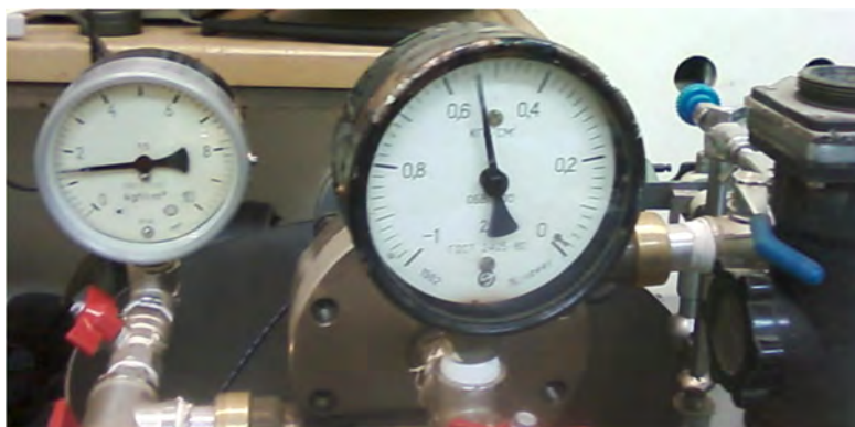
Рис. 5. Барометрическое давление в зоне вихревой воронки КСД и давление на стенке улиточного завихрителя при расходе 1 л/с
