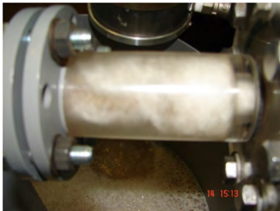
Рис. 9. Вихревое неустановившееся движение жидкости в выходном патрубке
