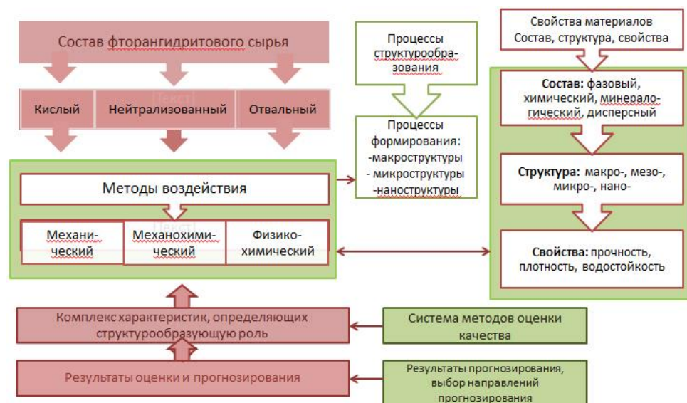
Рис. 1. Методология тестирования вяжущих свойств активированного фторангидрита Fig. 1. Methodology for testing binding properties of activated acid fluoride raw materials for building material production
