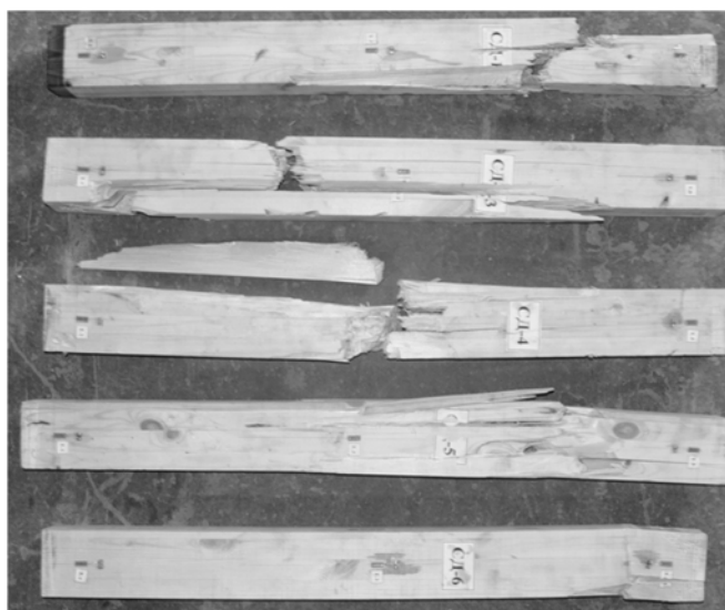
Рис. 7. Стойки после разрушения сжимающей динамической нагрузкой
