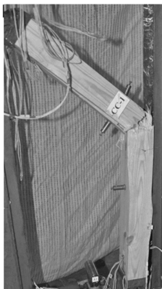
Рис. 3. Картина разрушения образцов при статической нагрузке, разрушающая нагрузка для образцов
