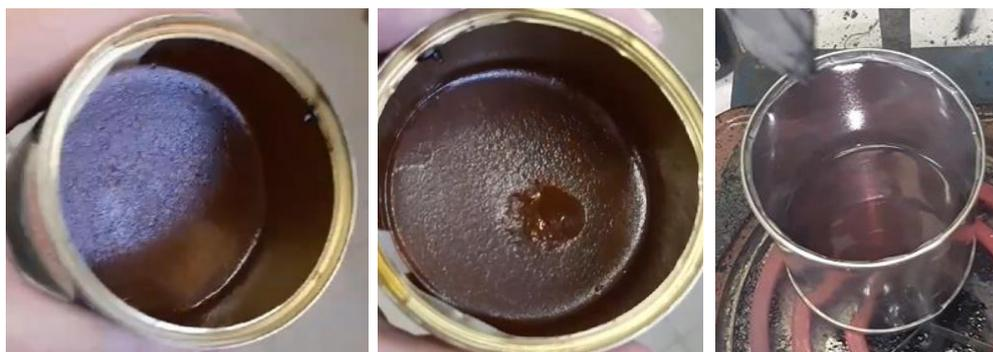
Рис. 2. Изменение агрегатного состояния ЛТМ от  $-35$  до  $68$  °С
