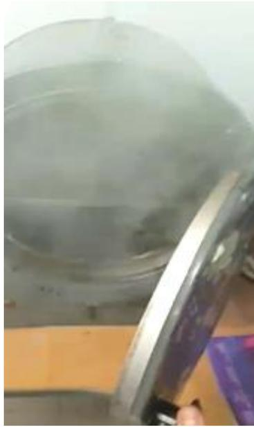
*Рис. 1.* Интенсивное испарение летучих компонентов на этапе прогрева образцов при 163 °С
