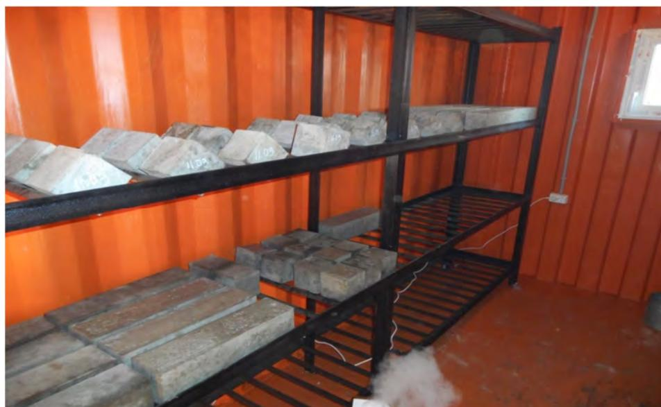
Рис. 4. Хранение цементобетонных образцов в полевой камере нормального твердения
