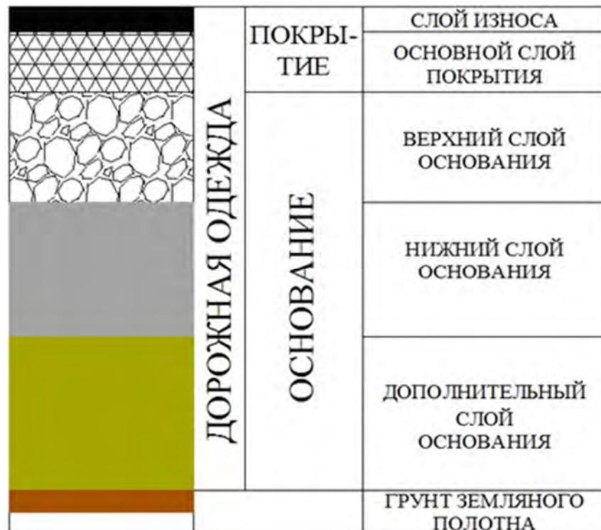
Рис. 1. Унифицированная конструкция дорожного полотна
