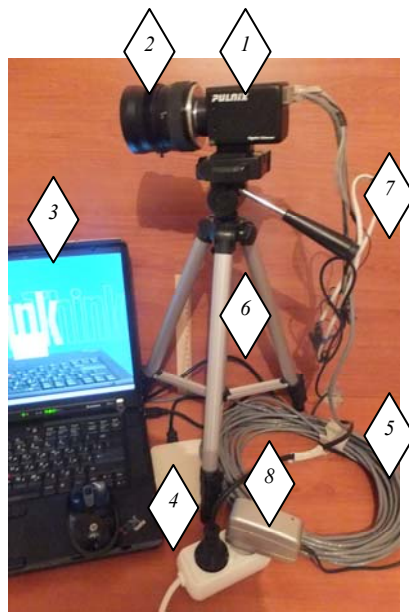
Рис. 2. Общий вид скоростной цифровой видеокамеры TMC-6740GE и объектива Navitar DO-5095:
