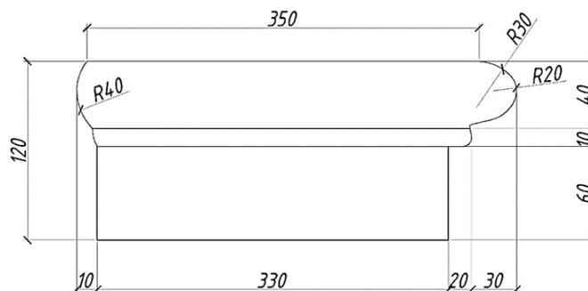
Рис. 23. Обмерочный чертеж профиля ступени. Чертёж М.А. Вольных, 2016 г.
