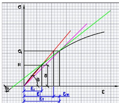
Рис. 2. Зависимости « $\sigma_i - \varepsilon_i$ » упругопластического состояния асфальтового бетона
