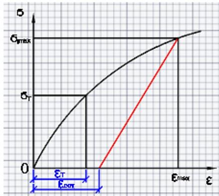
Рис. 4. Зависимость « $\sigma_i - \varepsilon_i$ » упруговязкого тела с учетом последействия
