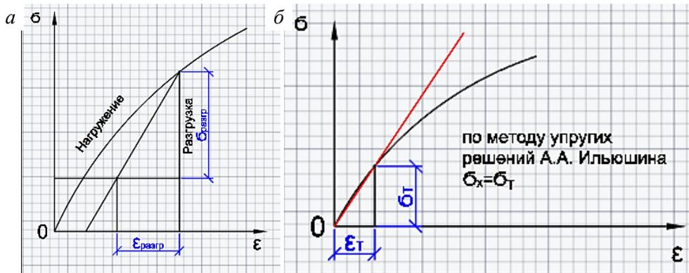
Рис. 1. Диаграмма « $\sigma - \epsilon$ » упругопластического деформирования анизотропного тела: а – стадия «нагружение-разгрузка»; б – зависимость между  $\epsilon_i$  и  $\sigma_i$  на участке деформирования, равная  $\sigma_T$
