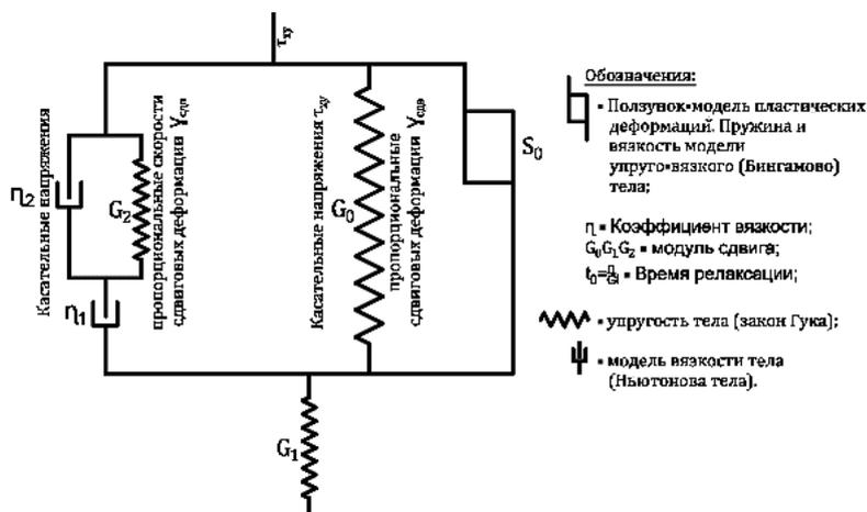
Рис. 5. Обобщенная реологическая модель асфальтового бетона
