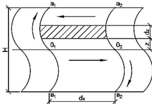
Рис. 3. Сдвиговые деформации в асфальтобетонной плите
