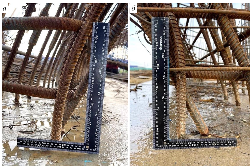
Рис. 2. Определение угла загиба арматурного выпуска:
