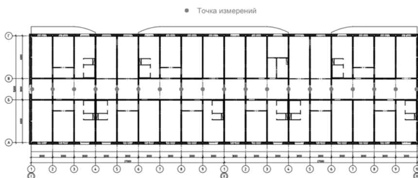
Рис. 3. Схема наблюдений для регистрации микросейсмических колебаний на типовом этаже здания
