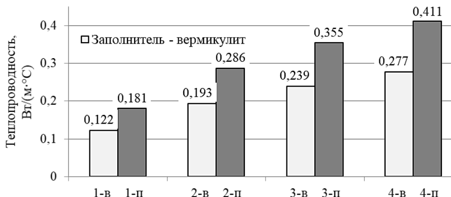
Рис. 5. Теплопроводность легких бетонов с пластификатором
