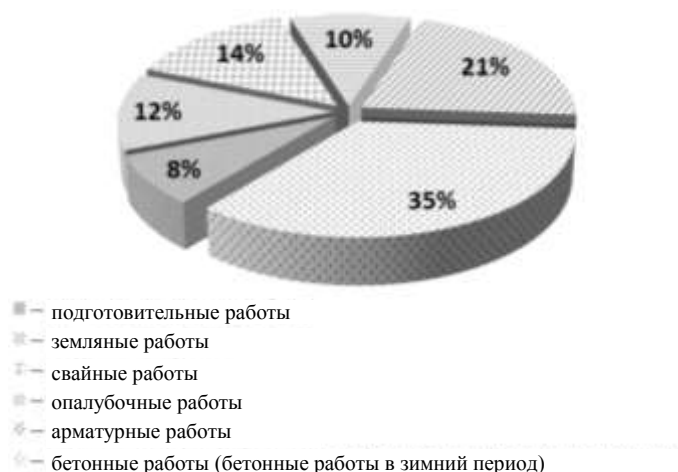
Рис. 2. Диаграмма распределения нарушений, выявленных при строительном контроле представительного числа строительных организаций
