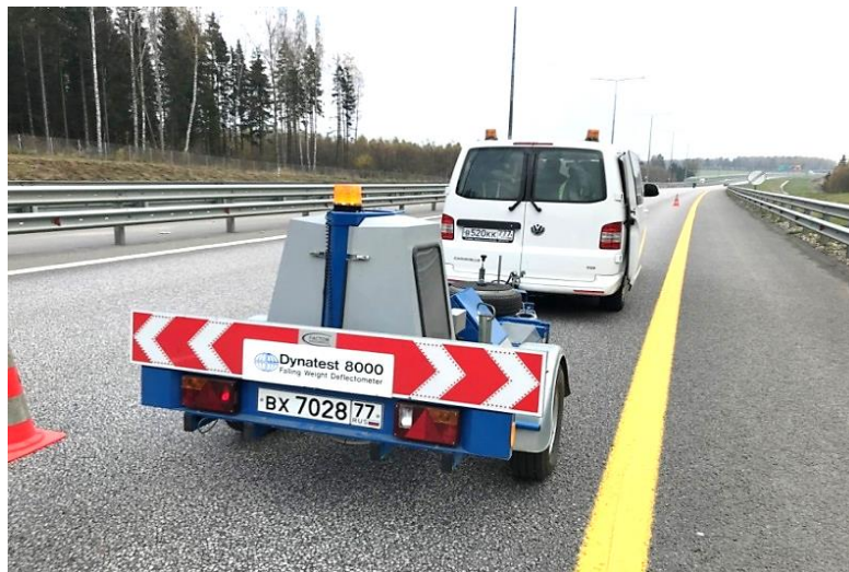
Рис. 1. Установка FWD Dynatest 8000
