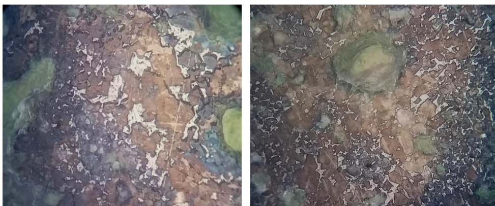
Рис. 6. Сростки алита Fig. 6. Alite agglomerations
