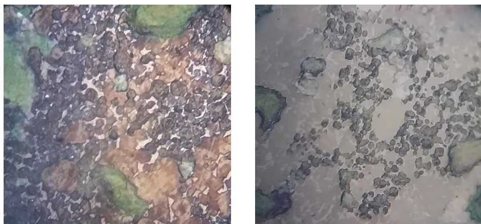
Рис. 8. Свободный оксид кальция на поверхности кристаллов алита в протравленном и непротравленном шлифе
