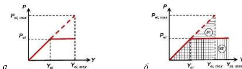
Рис. 1. Графическое представление гипотезы Н. Ньюмарка [14] о соответствии характерных параметров упругой и упруго-пластической систем
