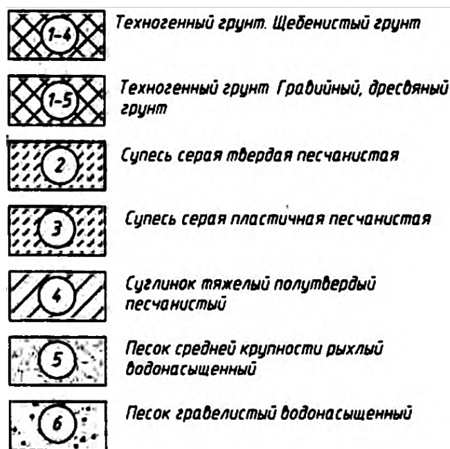
Рис. 3. Грунты инженерно-геологических изысканий Fig. 3. Geotechnical survey soils
