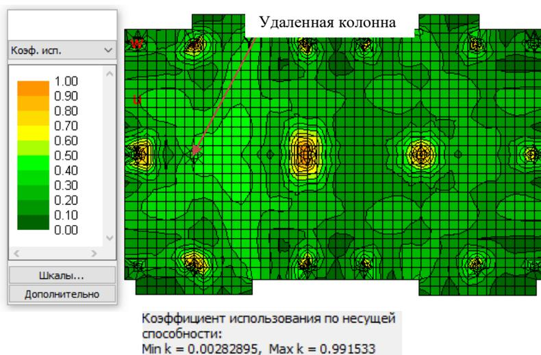
Рис. 5. Изополя несущей способности фрагмента перекрытия подвала в ВРС – стадия стабилизации после удаления средней колонны в подвале
