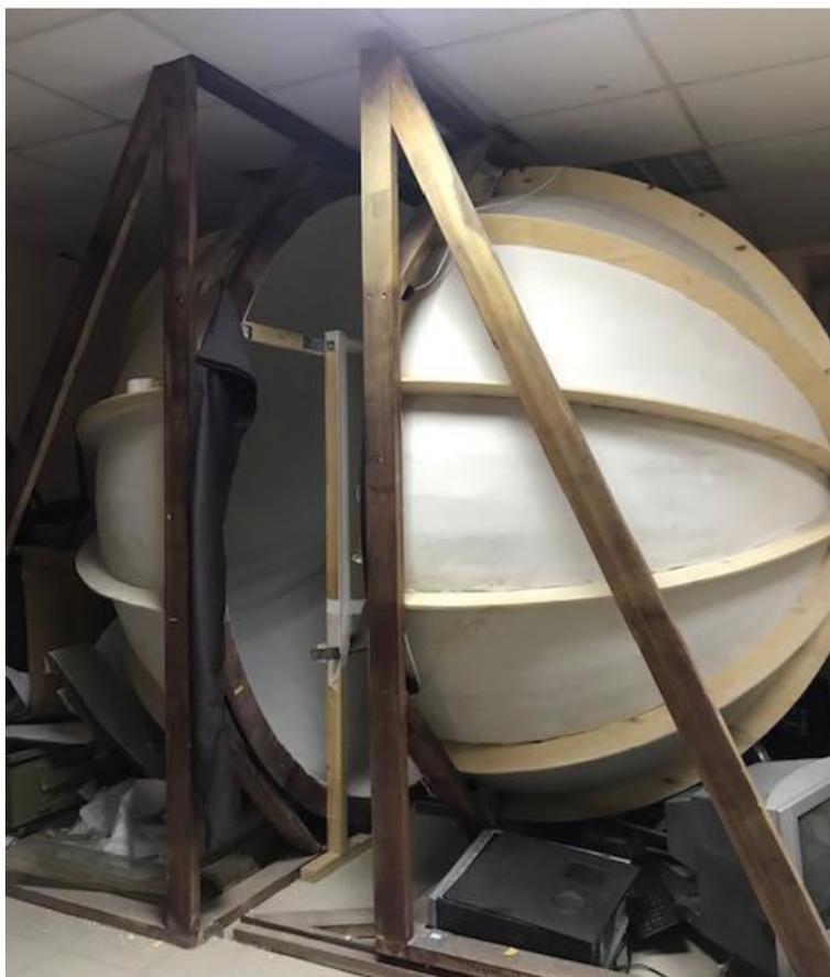
Рис. 7. Общий вид светомерных камер
