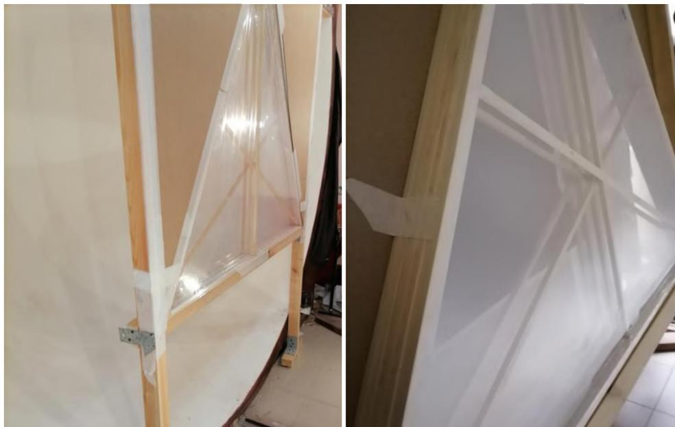
Рис. 8. Монтаж пленкопакетов в светомерных камерах
