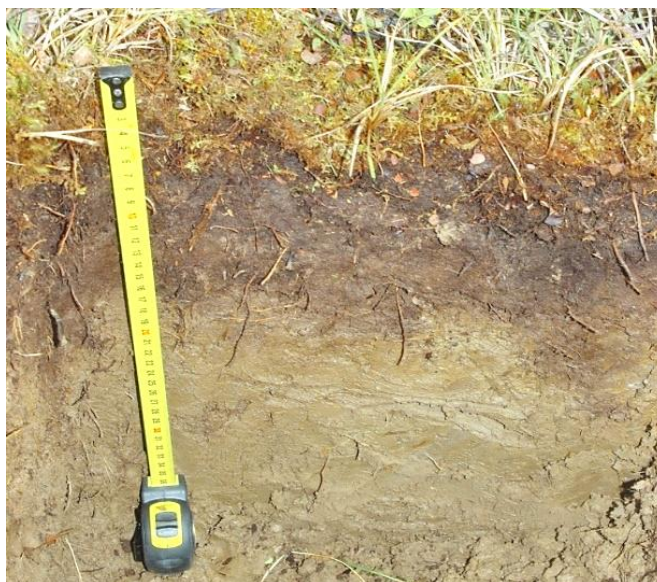
Рис. 6. Разрез, насыпные суглинки с примесью гравия, шлака, обломков кирпича
