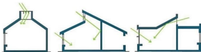
Рис. 5. Освещение верхним и верхнебоковым светом помещений школы. Схемы разрезов [19, с. 105]
