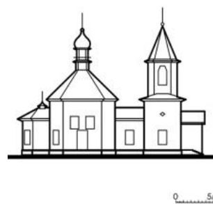
Рис. 20. Схема главного фасада церкви Владимирской в с. Нижнеманай Упоровского района. Схематичное изображение храма по результатам обмеров 2020 г. Выполнено А.А. Варанкиной
