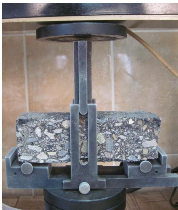
Рис. 2. Внешний вид образца из мелкозернистого асфальтового бетона типа Б в испытательной машине ИП 5150-50
