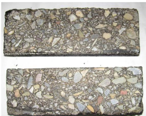
Рис. 1. Внешний вид образцов из мелкозернистого асфальтового бетона типа Б в поперечном профиле
